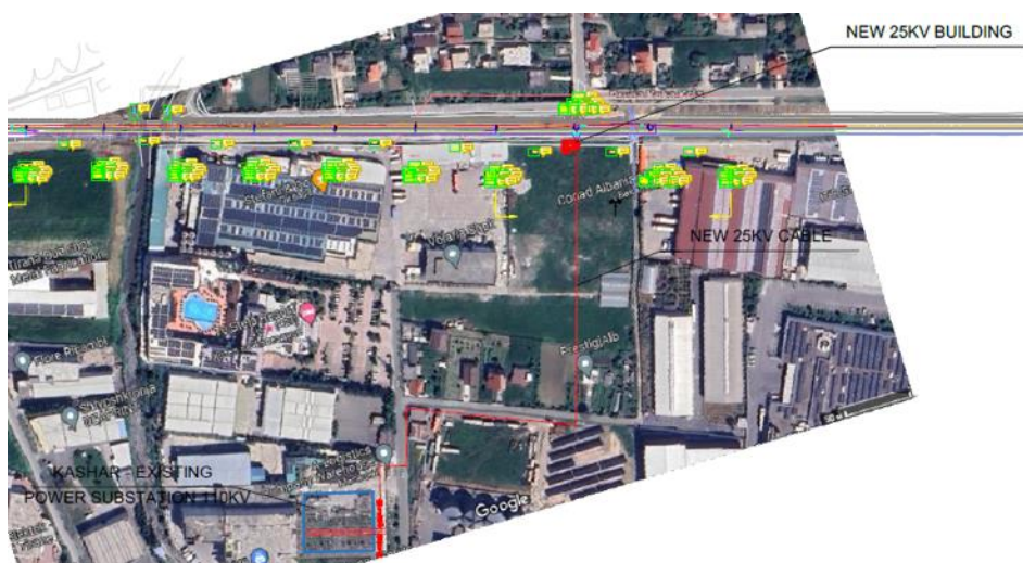
Figura 9 Alternativa 2 Transformator i ri 110kV/25kV brenda kufijve të fuqisë ekzistuese nënstationi Kashar dhe objekti i ri 25kV pranë hekurudhës
